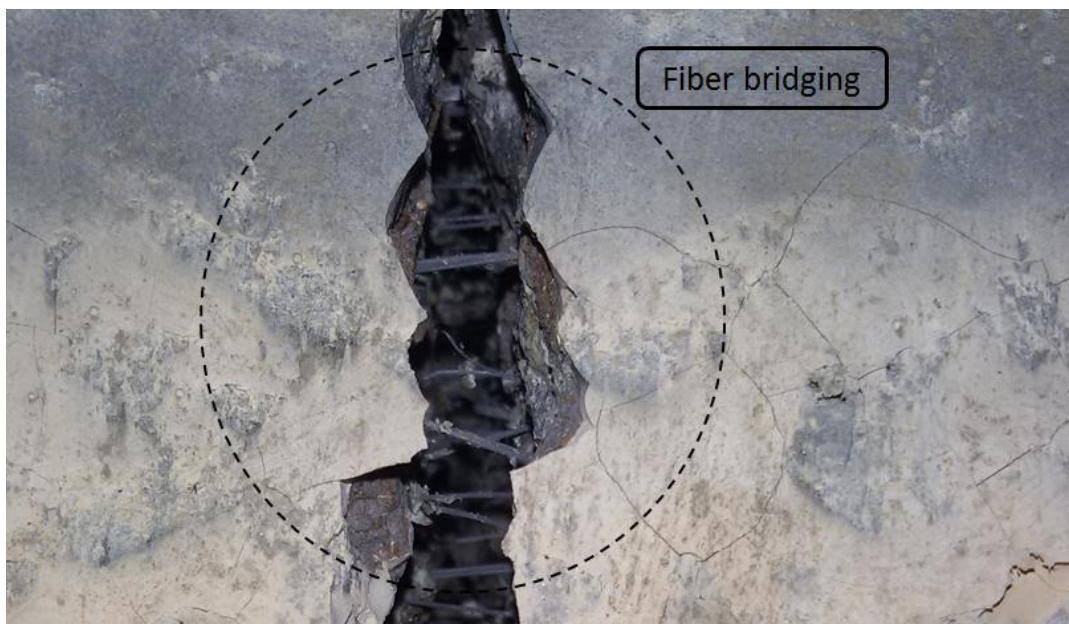
شکل ۶: نقش الیاف در پل زدن و جلوگیری از گسترش ترک
